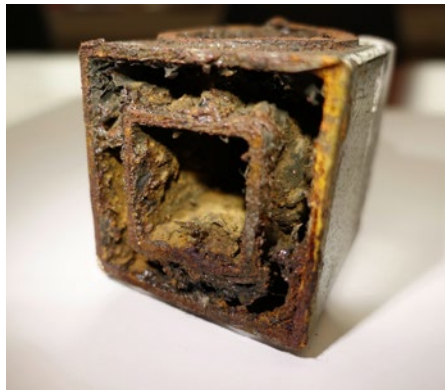
Verschlammungen im Verteiler der Fußbodenheizung beeinträchtigen die Funktionalität.
