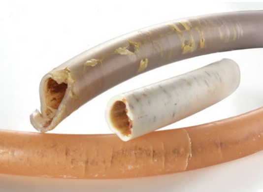
Sauerstoffdiffusion führt zu Versprödung und Undichtigkeiten der Rohre.
