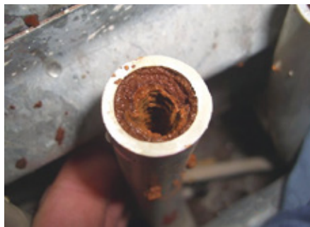
Die Innenrohrsanierung im Überblick: Das stark verschlammte Rohr (l.) wird mit einem Granulat behandelt, wodurch alle Ablagerungen entfernt werden (Mitte). Abschließend wird ein Beschichtungsmaterial in 0,4 bis 0,7 mm Stärke eingebracht, welches das Rohr sauerstoffdicht nach DIN 4726 versiegelt.
