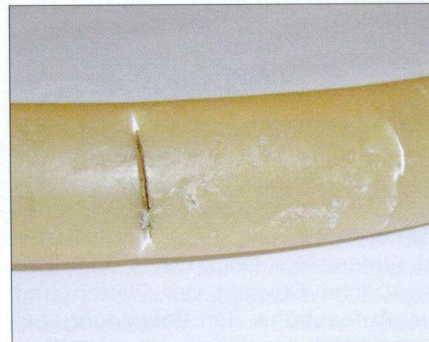
Alte Kunststoffrohre können auch spröde werden und Risse bilden.
