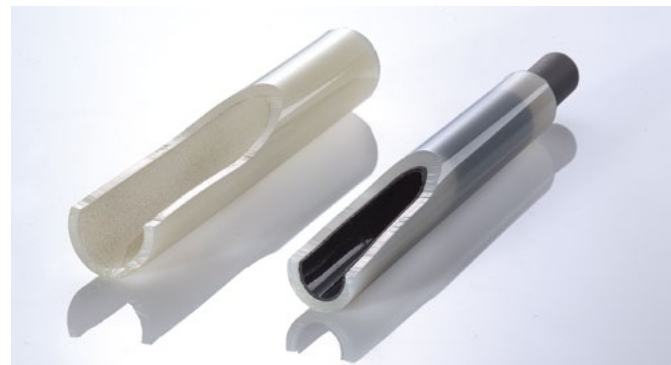
▲ Bild 3 • Sandgestrahtes und beschichtetes Rohr.
