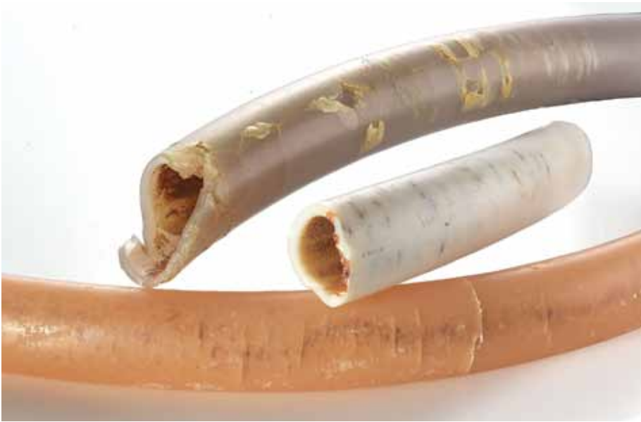
Sauerstoffdiffusion führt zu Versprödung und Undichtigkeiten.
