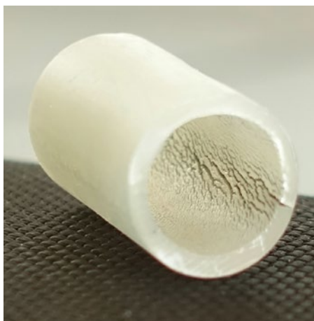
Versprödung an einem diffusions-offenen Kunststoffrohr mit Rissen an der Innenseite im Detail.
